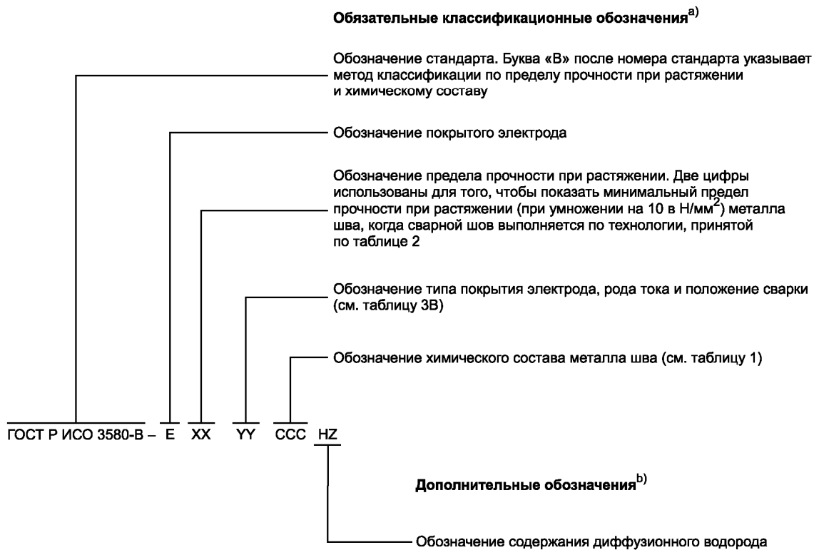
Рисунок А.2 — Метод классификации покрытых электродов по пределу прочности и химическому составу для сварки жаропрочных сталей
