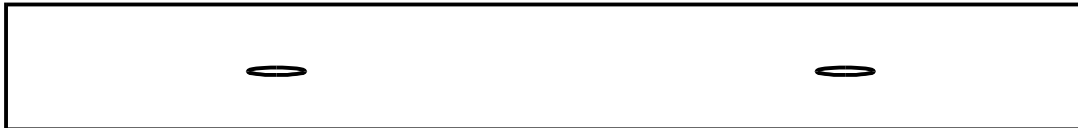
Пример 2 — две несплошности длиной по 6,4 мм
