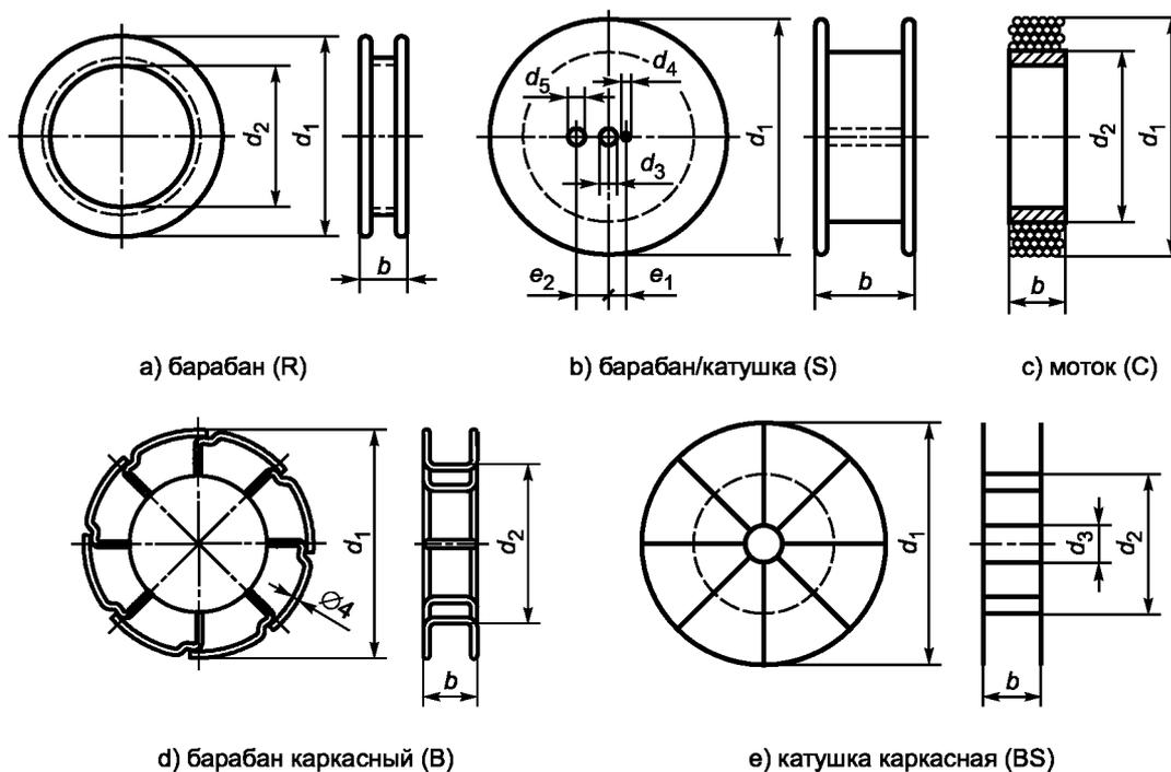
Примечание — Барабан/катушка (S) может иметь два отверстия под штифты
