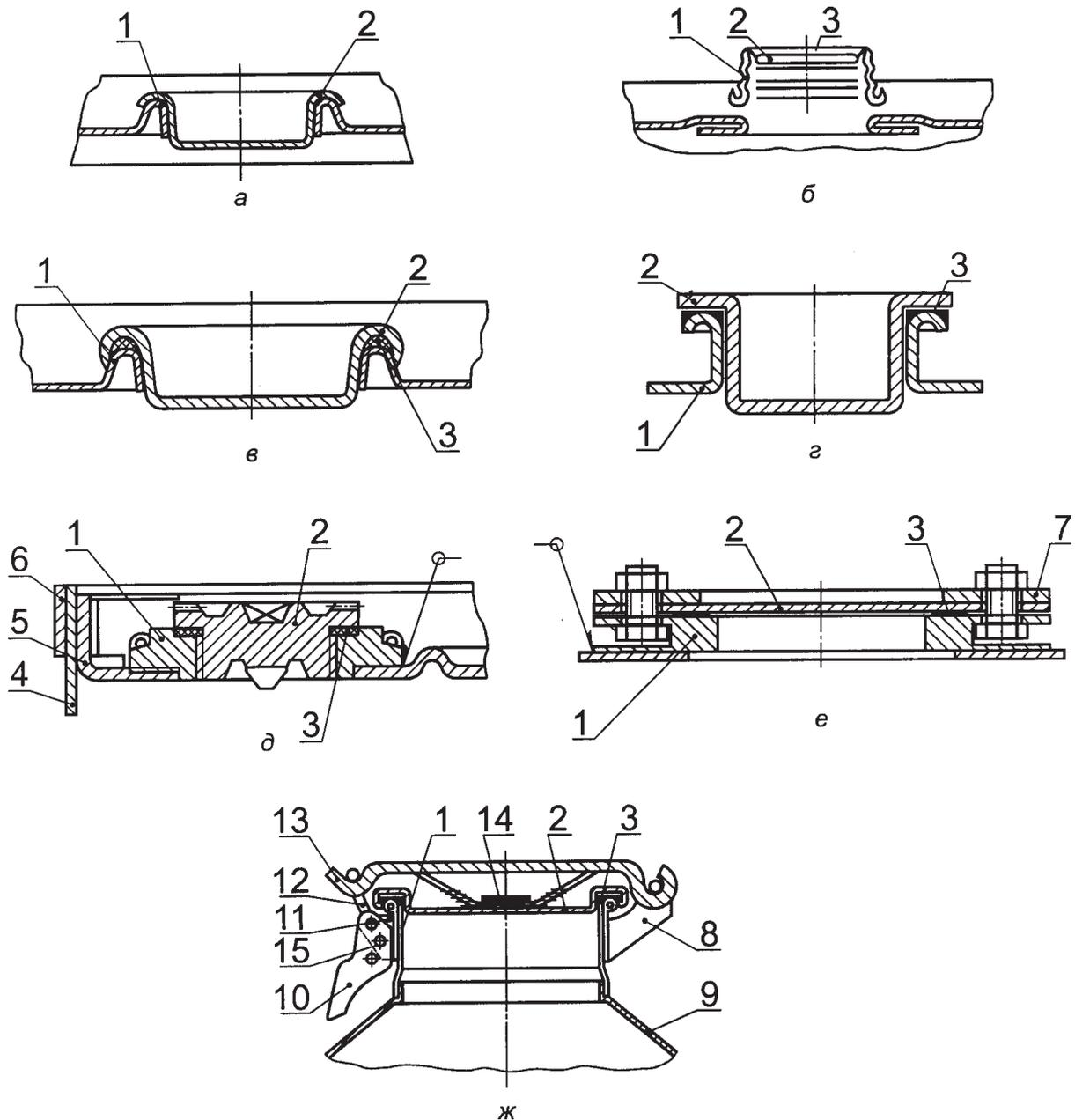
а, в — с вставляющейся крышкой; б, г, д — с крышкой (пробкой) на резьбе; е — с фланцевой крышкой; ж — с откидной крышкой
