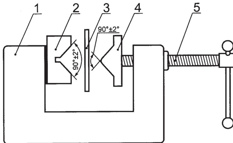
1 — струбцина; 2 — матрица; 3 — испытываемый образец; 4 — пуансон; 5 — винт
