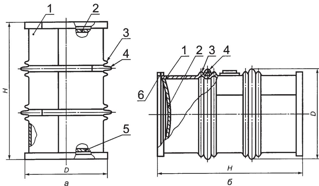
1 — корпус; 2, 5 — донья; 3 — зиг; 4 — обруч катания; 6 — обруч концевой
