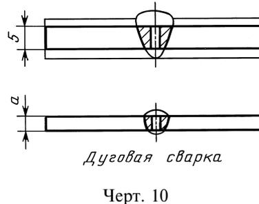
При испытании металла околошовной зоны при сварке давлением расстояние  $t$  отсчитывают от оси шва.
