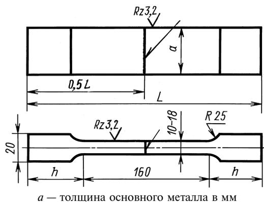
$a$  — толщина основного металла в мм
