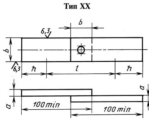
$a$  — толщина основного металла, мм;  $h$  — длина захватной части (выбирают в зависимости от конструкции испытательной машины), мм;  $l$  — длина рабочей части образца, мм
