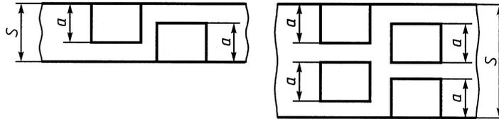
$S$  — толщина сварного соединения;  $a$  — толщина образца
