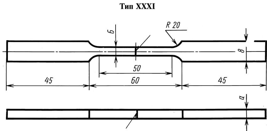
$a$  — толщина основного металла в мм
