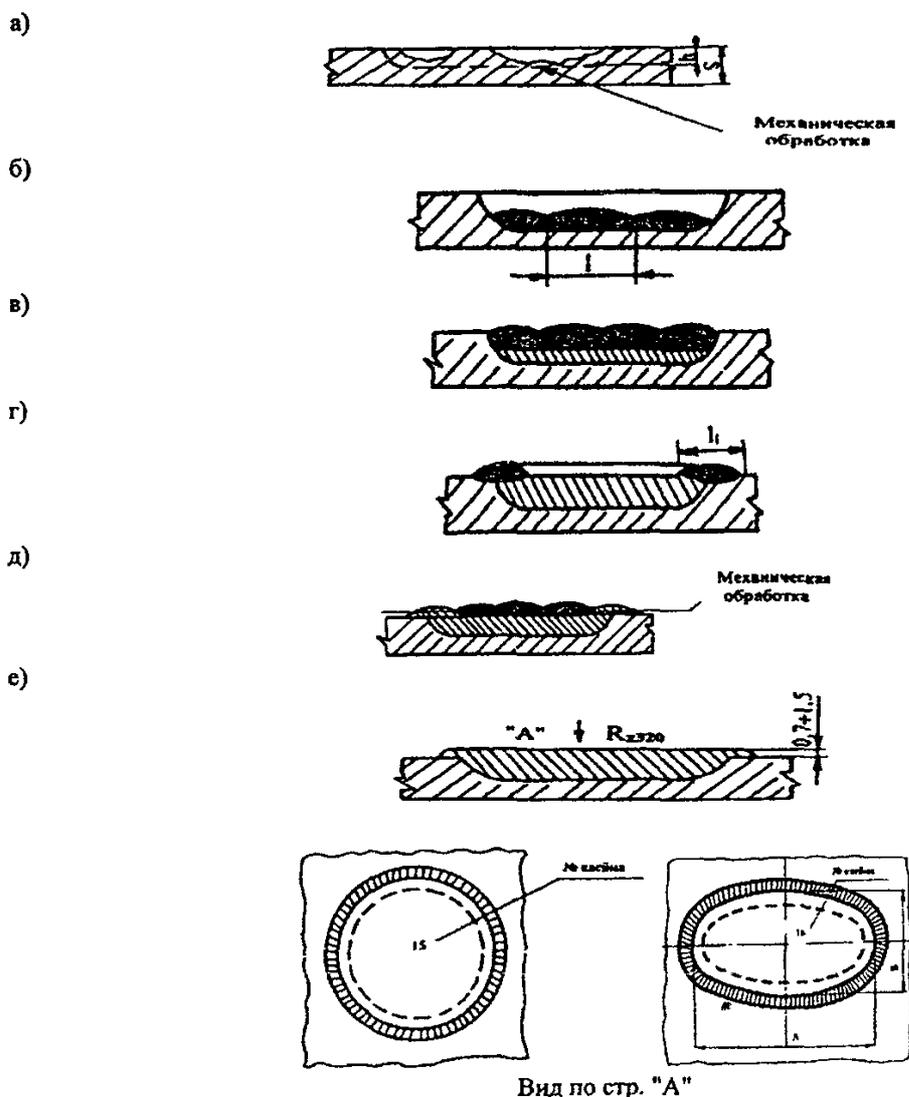
Рис. 12.19 Схема заварки каверн с круговой обработкой поврежденного участка:
