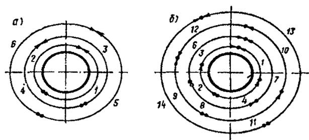
Рис.10.3. Порядок наложения швов при сварке вертикального неповоротного стыка труб одним сварщиком:
