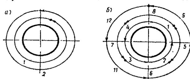
Рис.10.4. Порядок наложения швов при сварке горизонтальных стыков труб:
