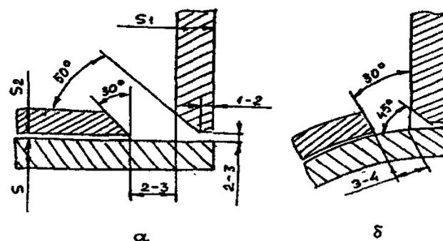
Рис.12.12. Подготовка кромок под сварку узла врезки типа "а" отводной патрубков с усиливающей накладкой":
