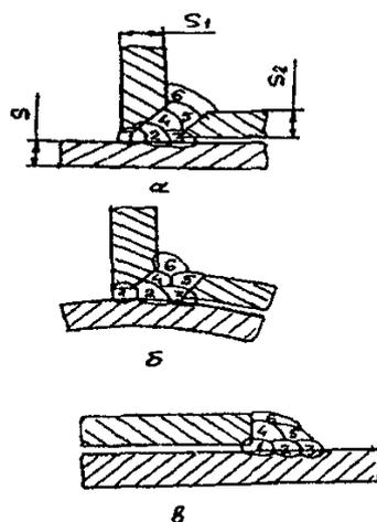
Рис.12.13. Последовательность наложения валиков сварного шва при сварке узла врезки типа "а" отводной патрубков с усиливающей накладкой".
