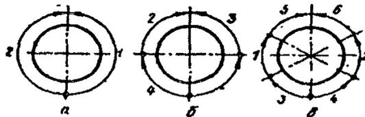
Рис.10.11. Порядок сварки неповоротного стыка:
