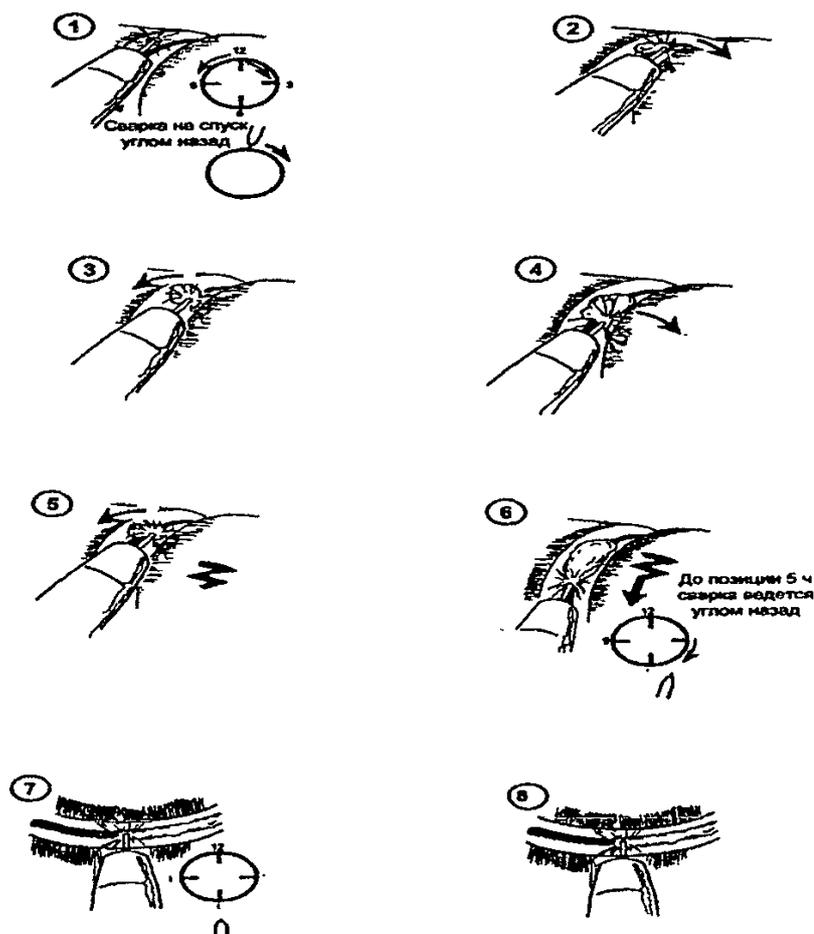
Рис.10.12. Техника механизированной сварки методом STT
