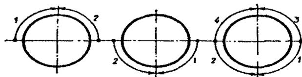
Рис.10.6. Схема аргодуговой сварки неплавящимся электродом поворотных стыков в два поворота. 1...4 - последовательность выполнения швов.
