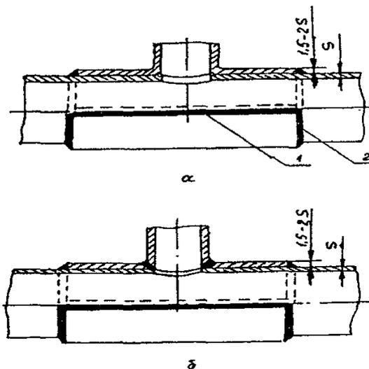
Рис.12.15. Конструктивное исполнение узла врезки типа "разрезной тройник".
