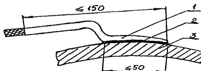
Рис.12.3.Рекомендуемая конструкция соединения катодного вывода с трубой.
