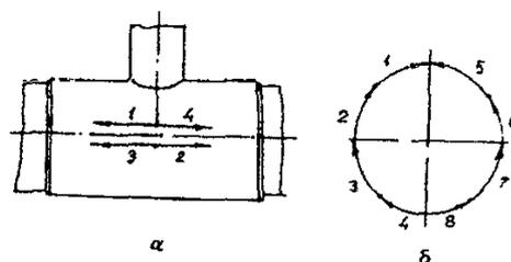
Рис.12.17. Порядок наложения сварных швов.
