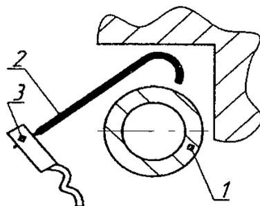
Рис.6.1. Сварка изогнутым композиционным электродом в стесненных условиях:
