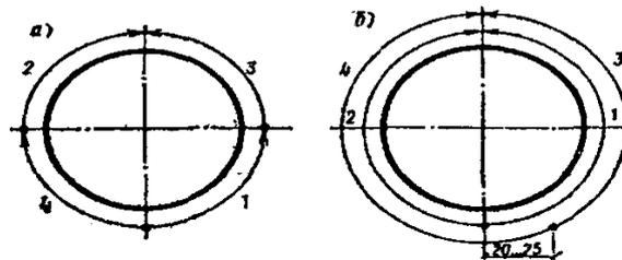
Рис.10.7. Схема аргодуговой сварки неплавящимся электродом неповоротных стыков: а)- сварка корневого шва; б)- второго и последующих швов; 1...4 - последовательность наложения швов.
