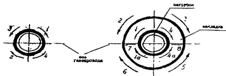
Рис.12.14. Схема сварки узла врезки типа "а" отводной патрубков с усиливающей накладкой". Цифрами отмечена очередность наложения слоев внутреннего и внешнего сварного шва.
