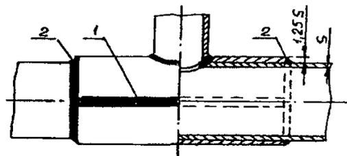
Рис.12.18. Конструктивное исполнение узла врезки типа "разрезная муфта"
