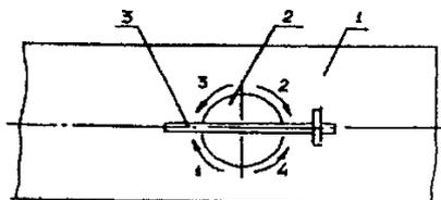
Рис.12.10. Схема сварки при заделке технологического отверстия с помощью стального козырька.
