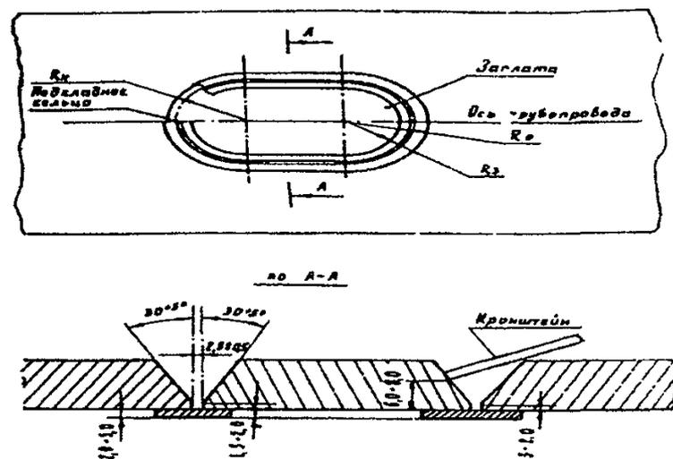
Рис.12.4. Схема разделки кромок под сварку заплаты.
